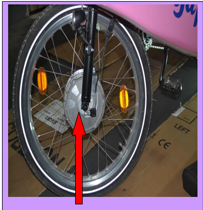
Rueda delantera donde queda alojado el motor
