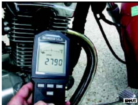
Colocación del Tacómetro
